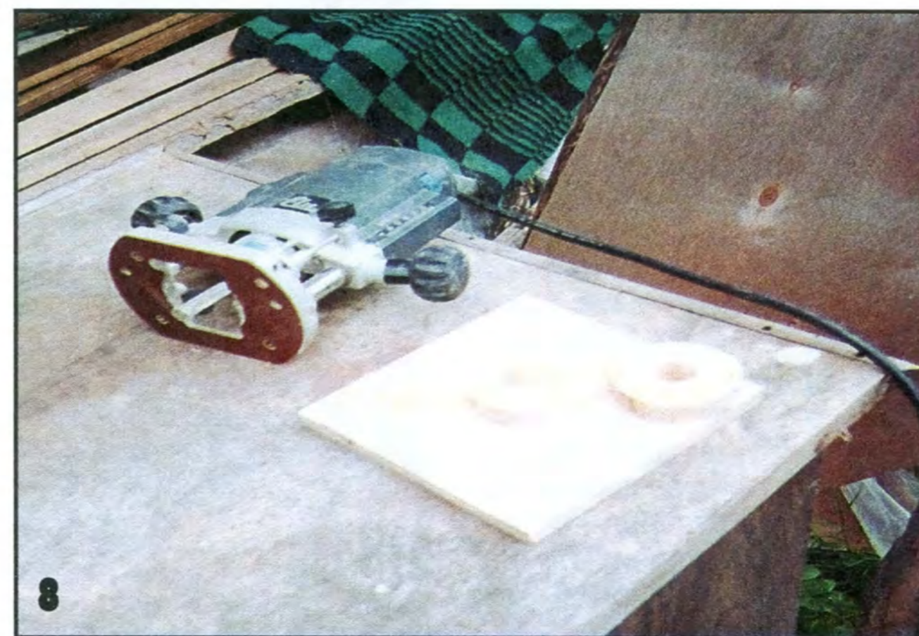
Вырезаю две контрольные шайбы (с внутренними диаметрами 35 и 22 мм) и делаю кондукторы для изготовления опорных шайб.
