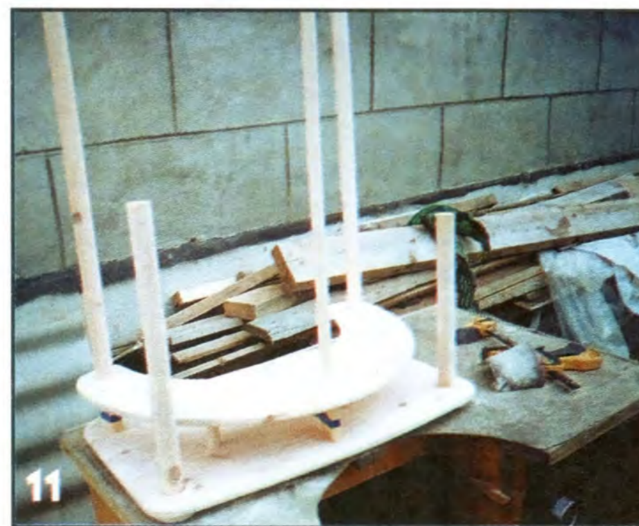
Креплю изолянтной к стойкам ограничители высоты второй полки и приклеиваю на место вторую полку с ее опорными шайбами.
