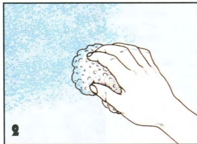
2 Влажный отжатый тампон из натуральной губки применяют для покрытия прозрачным лаком или для быстрого и равномерного растушевывания краски.
