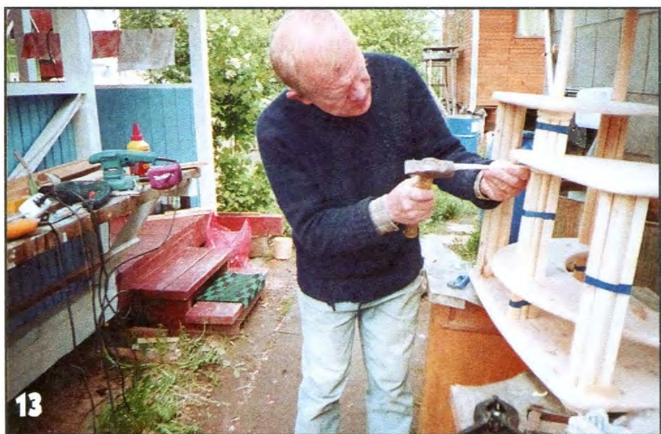
13 Опорные шайбы фиксирую шкантами длиной 70 мм, которые забиваю на клею в заранее просверленные отверстия.
