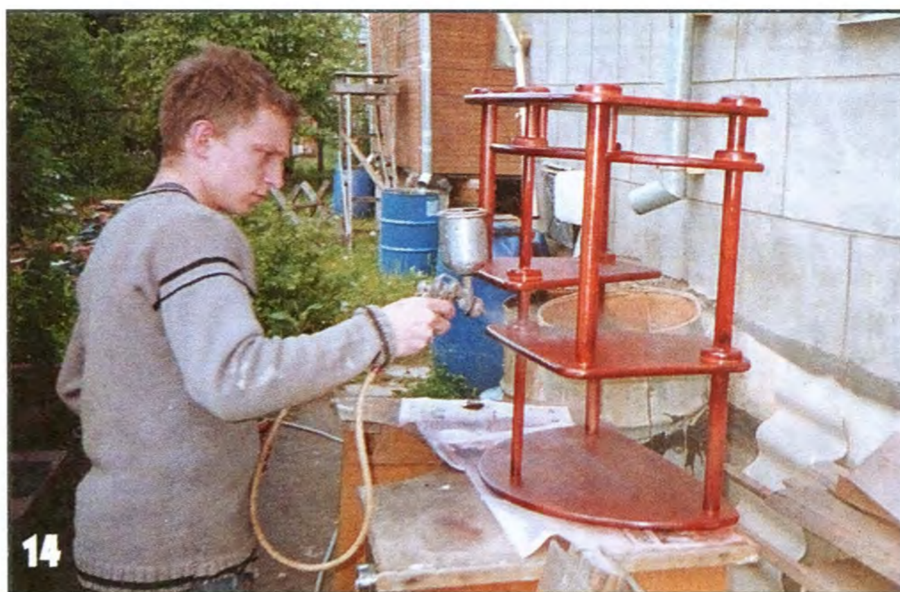
14 Жардиньерку окрашиваю морилкой и лакирую, начиная с нижних поверхностей полок (на фото).
