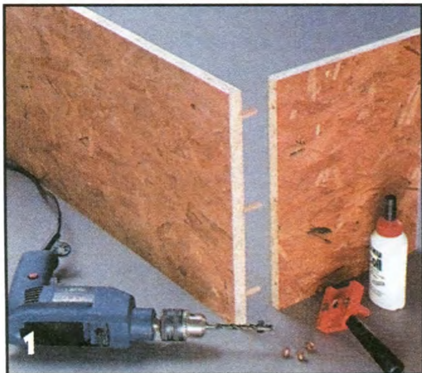
1 Угловые соединения деталей корпуса выполняют на шкантах с клеем.
