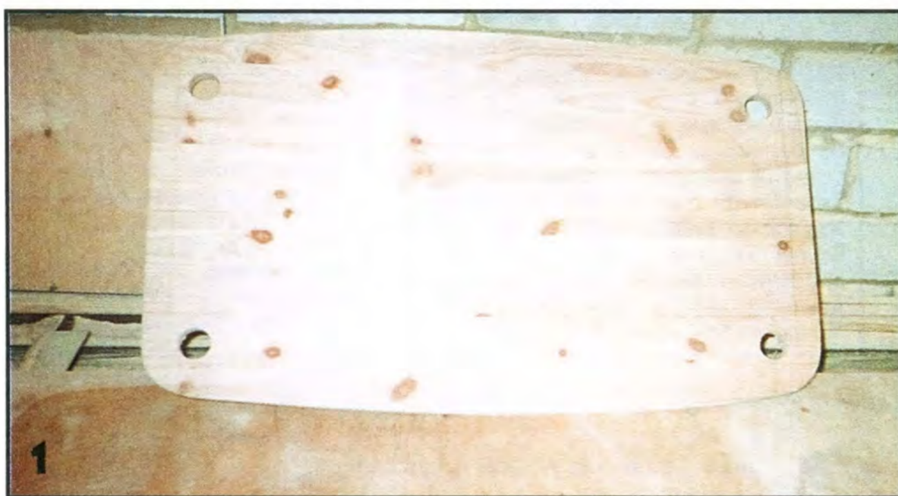
Детали и заготовки (здесь основание и вторая полка) я вырезал электролобзиком, предварительно разметив их на мебельных щитах.
