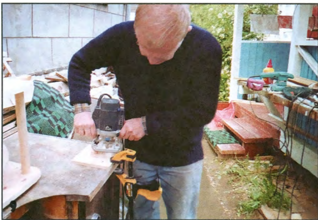
Вырезав заготовки для шайб и просверлив в них центральное отверстие, завершаю изготовление шайб обкаткой их фрезой по кондуктору.
