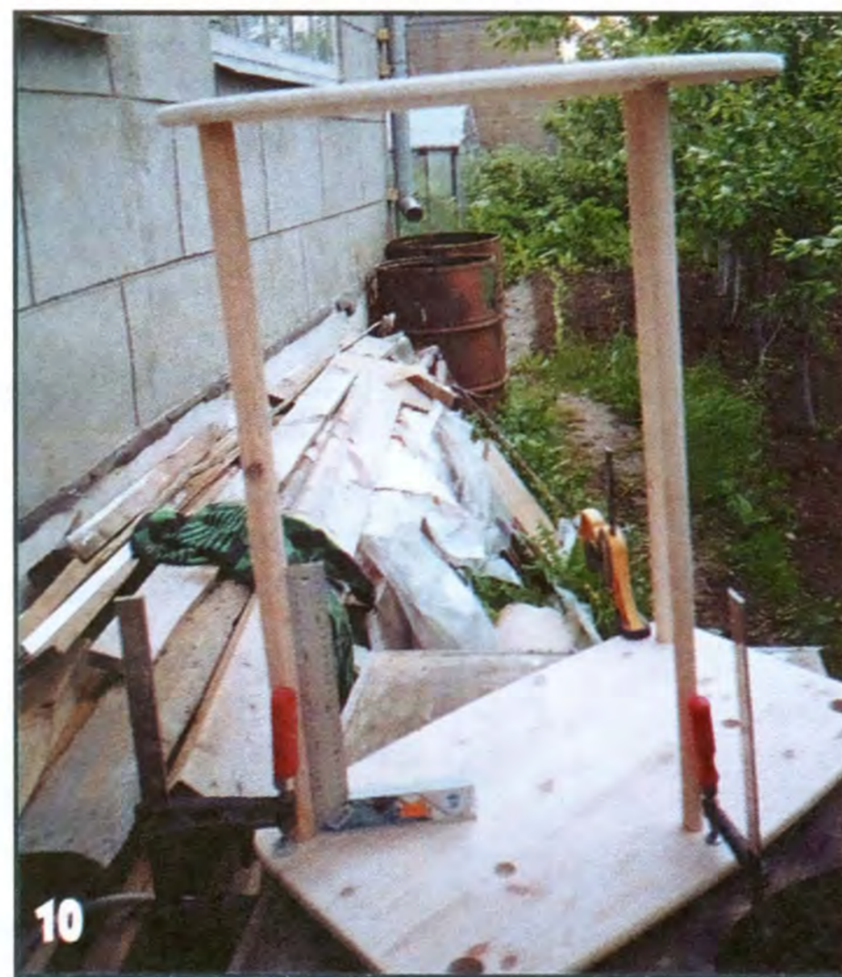
На концы всех стоек насаживаю на клею опорные шайбы, а затем три длинные стойки приклеиваю к основанию (верхняя полка фиксирует стойки).
