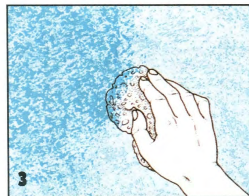
3 При использовании в отделке краски двух цветов наносят первую тонким слоем, ждут, когда она высохнет, и новой губкой наносят второй декоративный слой.
