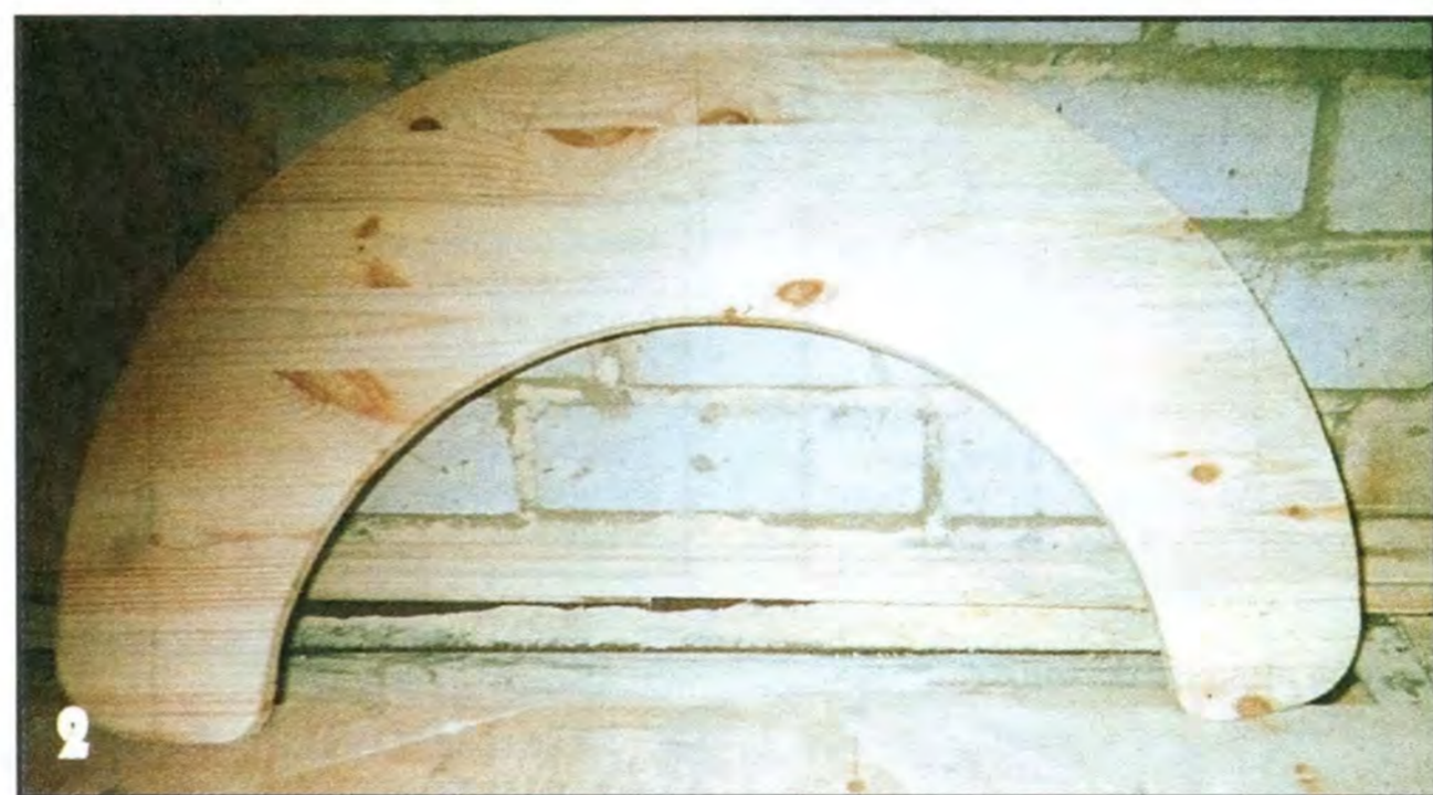
Детали и заготовки (здесь основание и вторая полка) я вырезал электролобзиком, предварительно разметив их на мебельных щитах.
