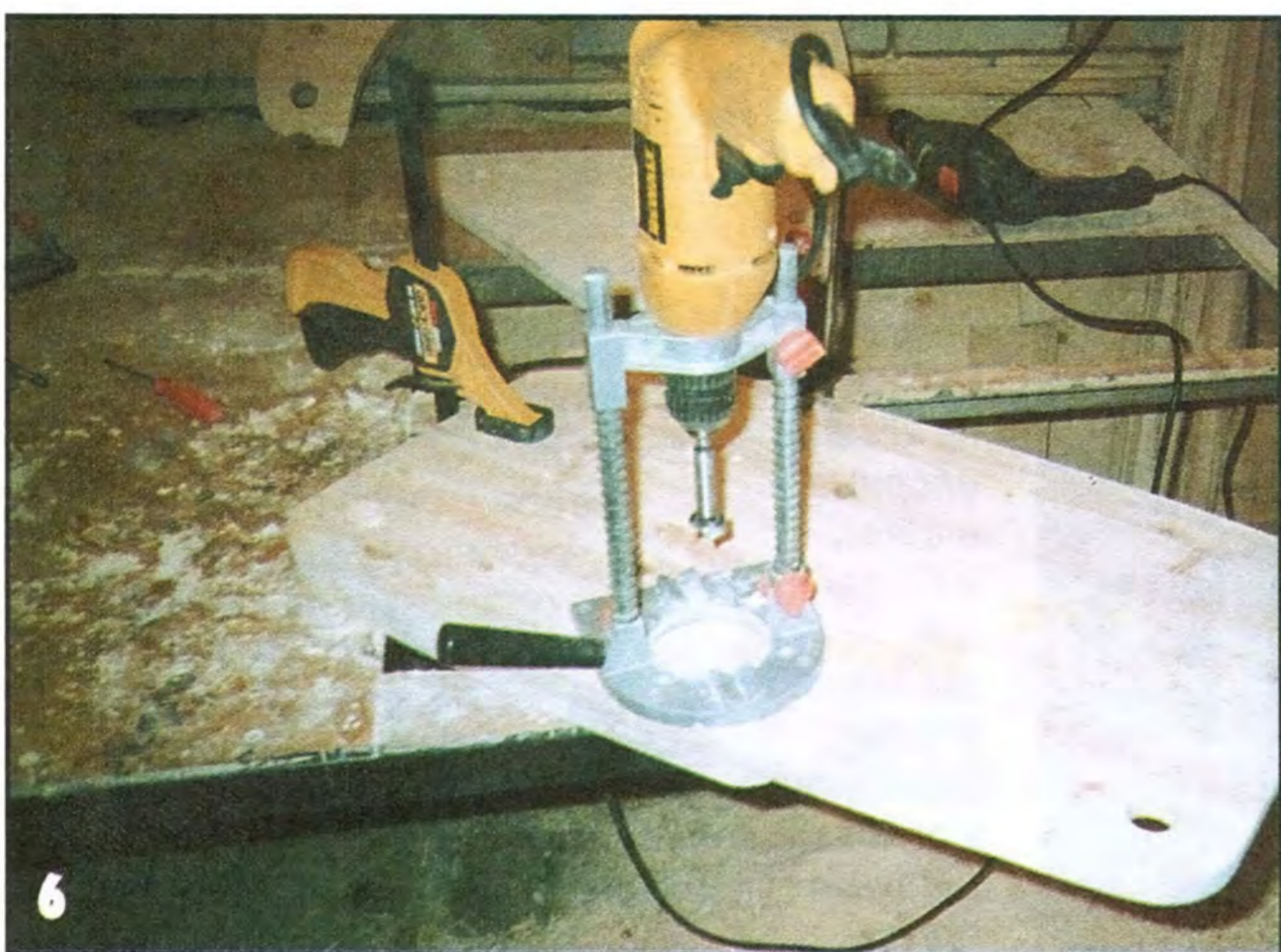
Заготовки деталей третьей полки вырезал с припусками, затем обкатываю их фрезой по контуру основания и, наконец, сверлю в них отверстия под стойки (на фото).
