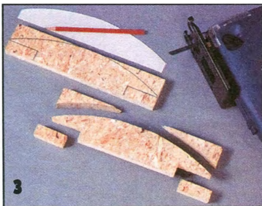
3 Все пять держателей-сегментов запиливают по окружности с радиусом 270 мм. В трех средних держателях делают вырезы под вертикальные стойки дверной рамы.
